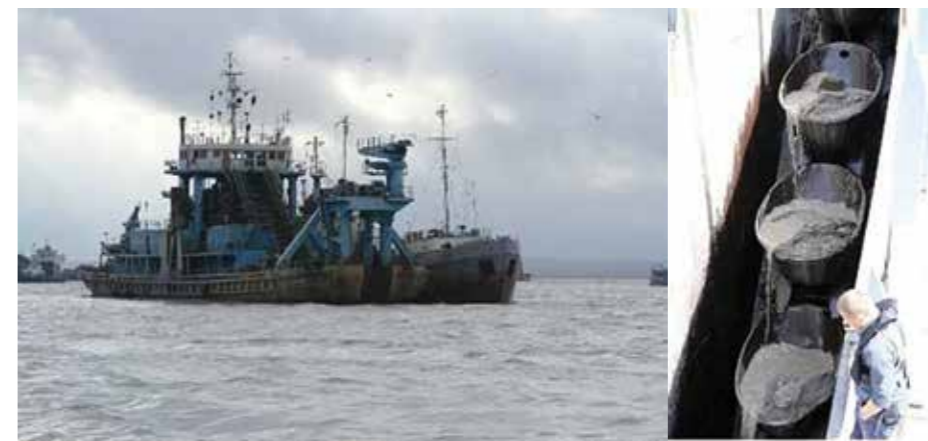
а) – морской многочерпаковый самоходный земснаряд «Балтийская землечерпалка»; б) – ковш многочерпакового земснаряда «черпаковая цепь», заполненная грунтом
