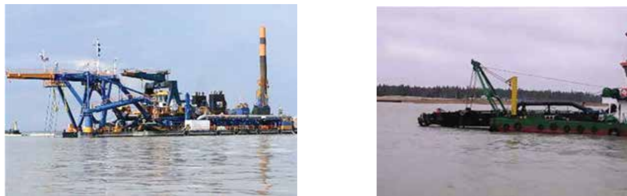
а) — фрезерный землесос; б) — рабочий орган фрезерного землесоса
