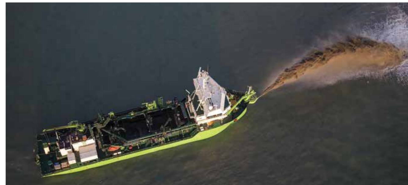
Самоотвозный трюмный земснаряд с системой цифрового контроля режимов работы компании DEME
