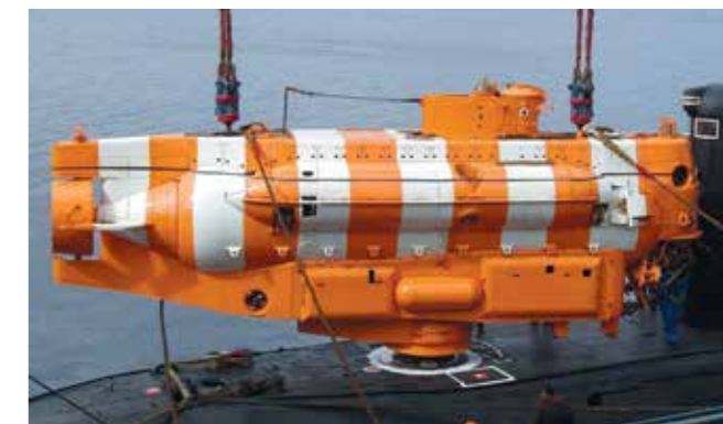
Корпус ГСА «Бестер» выполнен из титанового сплава
