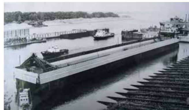
Док-понтон «Ока» для транспортировки АПЛ проекта 945 «Барракуда», 1983 ГОД
