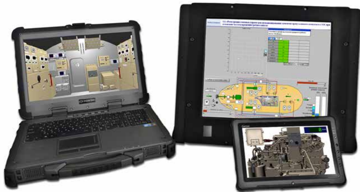
Рисунок 5. Комплекс информационной поддержки эксплуатации энергетического оборудования ПЛ проекта 636.3, обучения и тренажа личного состава (ИПЭ-30ДГ)
