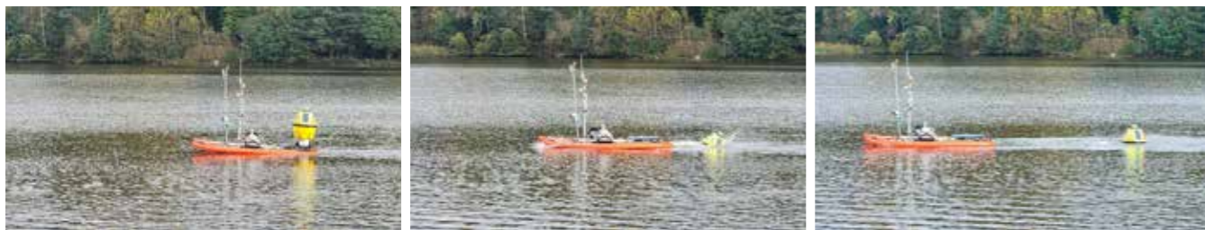
Пример выполнения задачи по автономному сбросу в заданной точке научно-исследовательского буя производства бренда NAESCO с помощью автоматизированного конвейера
