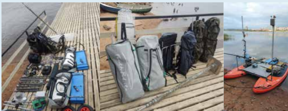
СМНС «Лоцман» в транспортном состоянии для пешей переноски и в собранном виде перед выходом на автономную миссию
