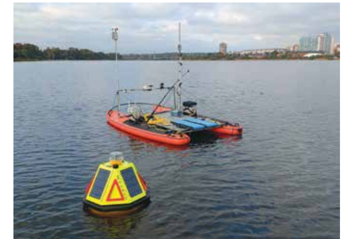
Пример выполнения сопряженной миссии по стабилизации МРТК «Лоцман» в заданной точке, спуску ТНПА и выполнении ретрансляции сигналов управления и телеметрии с мини-ТНПА (производства СПбГМТУ) в процессе подводного осмотра
