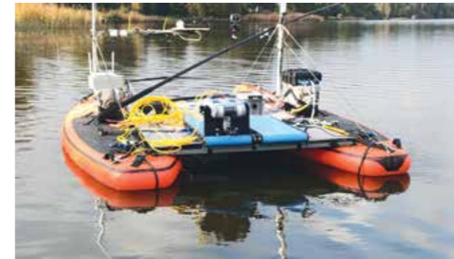
Пример выполнения сопряженной миссии по стабилизации МРТК «Лоцман» в заданной точке, спуску ТНПА и выполнении ретрансляции сигналов управления и телеметрии с мини-ТНПА (производства СПбГМТУ) в процессе подводного осмотра
