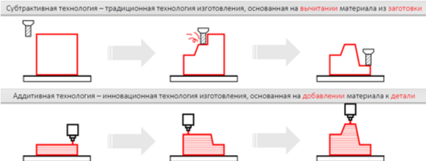
Рис. 1 – Иллюстрация отличия вычитания материала из заготовки от выращивания заготовки
