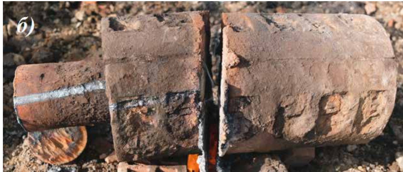
Рис.1. Дистанционная разделительная лазерная резка стального вала переменного сечения. Остров Сахалин, залив Анива, берег бухты Лососей. б) Разрезанное сечение диаметром D3. Время резки 38.5 мин.
