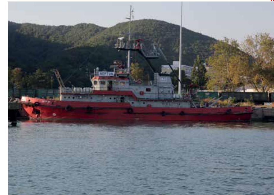
Пилотный проект судна специального назначения НЕПТУН, проект-14613, длина - 39,8, ширина - 7,8, осадка 2,2, водоизмещение - 385 т.
