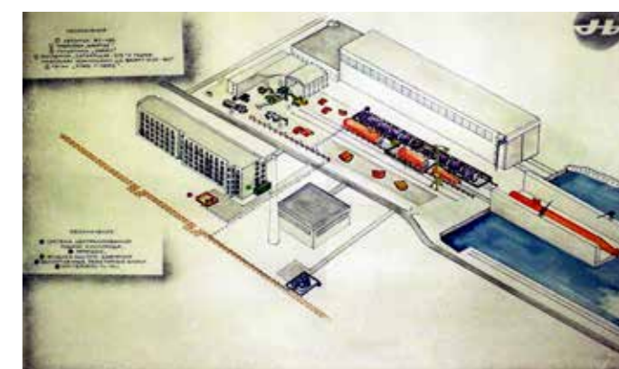
Рисунок 3. Начальная схема концепции развития стапельных мощностей судоремонтного завода "Нерпа"
