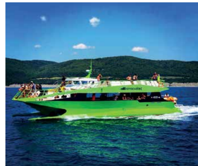
Моторный прогулочный волнопронизывающий катамаран типа «Барракуда»
